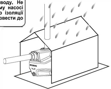
Взимку, вживаючи заходів проти замерзання для водяного насоса взимку, не закривайте двигун або насос легкозаймистими матеріалами для захисту від замерзання, бо це може спричинити пожежу, та не накривайте теплоізоляційний матеріал на двигуні, інакше це призведе до порушення вентиляції та тепловідведення, що легко призводить до пожежі.
