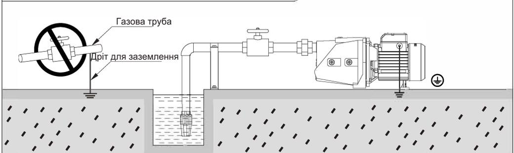
1. Під час роботи електричного насоса, якщо необхідно відрегулювати розташування насоса або провести якісь інші дії, щоб торкнутися насоса, спочатку потрібно відключити живлення. Категорично забороняється митися, плавати, випасати тварин тощо біля місця роботи насоса, щоб уникнути нещасних випадків.
