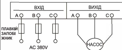
У разі необхідності подовжити або замінити кабель, використовуйте кабель із тими ж специфікаціями або технічними характеристиками, що перевищують вихідні, і зверніть увагу, що з'єднання повинно бути міцним, водонепроникним та ізованим.
