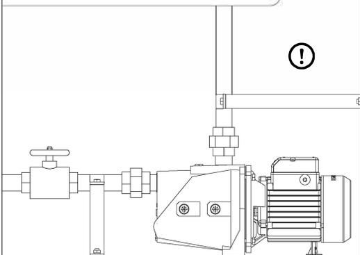
1. Використовуйте сталеву або гумову трубку (не надто м'яку, щоб всмоктування відбувалось рівномірно), щоб з'єднати ножний клапан і впускний отвір електричного насоса, а впускний трубопровід і частина з'єднання повинні бути герметичними, без витоків.
